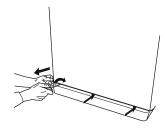
Contenitore per l'acqua di scarico: posizionare un contenitore basso e largo sotto il filtro per raccogliere l'acqua residua.
