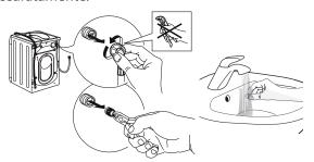
4. Inserire nuovamente il filtro a rete. Collegare nuovamente il tubo di carico al rubinetto dell'acqua e alla lavatrice. Non utilizzare un utensile per collegare il tubo di carico. Aprire il rubinetto dell'acqua e controllare che tutti i collegamenti siano ben serrati.
