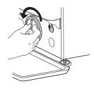
**4.** Rimozione del filtro: posizionare uno straccio di cotone sotto il filtro dell'acqua affinché assorba l'acqua residua. Estrarre il filtro dell'acqua ruotandolo in senso antiorario.
