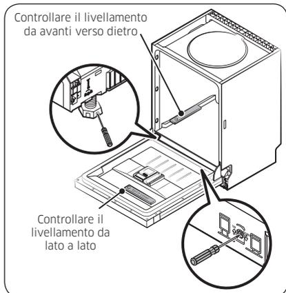
È possibile regolare l'altezza della lavastoviglie per livellarla. Da notare che in questi passaggi, la lavastoviglie non viene inserita completamente nel vano.
