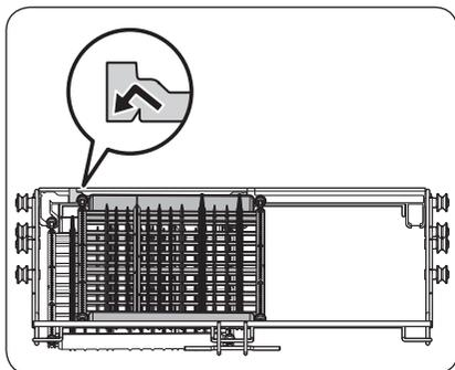
2. Sollevare delicatamente il perno sinistro del vassoio e portarlo verso il foro di apertura del telaio.
