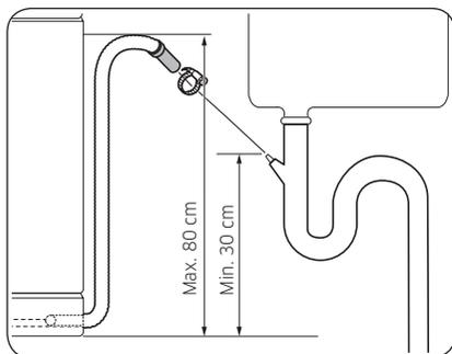
1. Collegare il tubo di scarico allo scarico.
