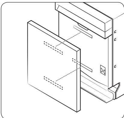
10. Fissare i due pezzi del fissatore hook-and-loop sulla parte esterna dello sportello e sul retro del pannello personalizzato come mostrato in figura.
