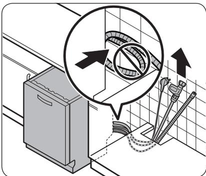
3. Far passare la spina del cavo di alimentazione, il tubo dell'acqua ed il tubo di scarico attraverso il foro del lavello.
