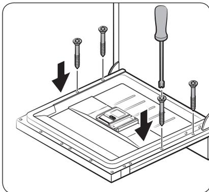
13. Fissare il pannello personalizzato allo sportello avvitando le 4 viti ( $\varnothing 4 \times 43$ ).
