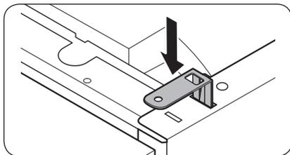
2. Inserire la lavastoviglie completamente nel vano sotto il piano.
