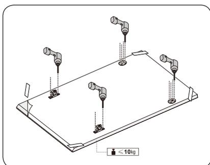
1. Appoggiare la dima di installazione sul retro del pannello decorativo e fissarla temporaneamente con nastro adesivo trasparente. Notare che il retro del pannello decorativo verrà fissato allo sportello della lavastoviglie.
