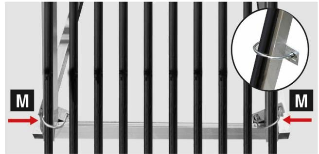
Utilizzando le altre 2 zanche di fissaggio (M), bloccare la parte laterale della struttura alla ringhiera stessa.
