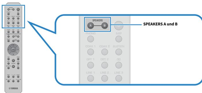
Bei jedem Drücken der Taste SPEAKERS A oder SPEAKERS B werden die betreffenden Lautsprecher ein-/ausgeschaltet.
