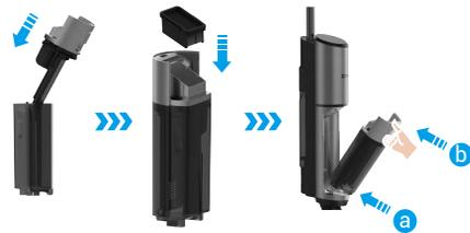
4. Installare di nuovo il coperchio e il filtro HEPA e riposizionare il recipiente dell'acqua sporca nel dispositivo.
