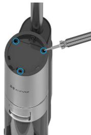
2. Utilizzare un cacciavite per rimuovere le tre viti indicate nella figura sopra, rimuovere il coperchio e i cavi collegati, quindi estrarre la scatola della batteria presente nel tubo.
