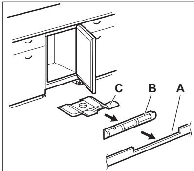
2. Reinigen Sie das Lüftungsgitter. (Siehe „Reinigung des Belüftungsfilters“. )
