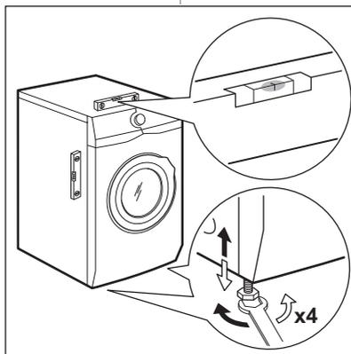
1. Installare l'apparecchiatura su un pavimento piano e solido. L'apparecchiatura deve essere in piano ed appoggiata in modo stabile. Verificare che l'apparecchiatura non sia a contatto con la parete o con altre unità e che vi sia ricircolo d'aria sotto all'apparecchiatura stessa.
