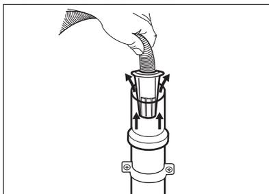
4. A un tubo verticale dotato di foro di ventilazione - Inserire il tubo di scarico direttamente in una condotta di scarico. Fare riferimento all'immagine.
