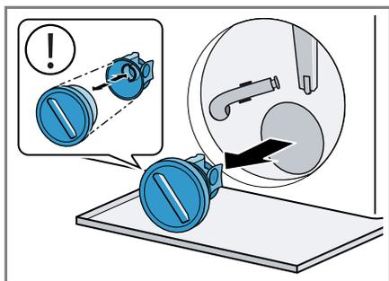
Il coperchio della pompa consta di due elementi costruttivi che possono essere smontati per essere puliti.
