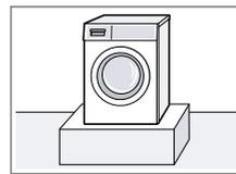
Fissare l'apparecchio con delle linguette di fissaggio → *Pagina 30*.
