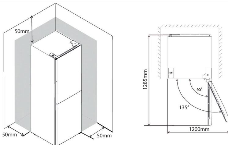
Appoggiate l'apparecchio su un pavimento solido in grado di sopportarne il peso anche quando è pieno. Evitate di appoggiarla su materiali elastici e risonanti che ne amplificherebbero il rumore. Regolate bene il livello orizzontale con gli appositi piedini.
