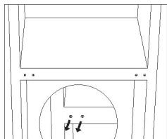
11. Plaats het apparaat rechtop en monteer de deur op het onder scharnier. Zorg ervoor dat het onderste scharnier in de deuropening is gevoerd. Verplaats de afdekking van de scharnieropening van de onderste deur van links naar rechts.
