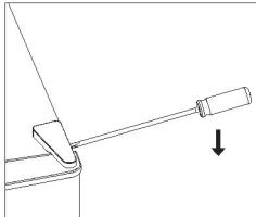
2. Schrauben Sie das obere Scharnier mit einem Kreuzschlitzschraubendreher ab.
