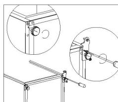
8. Odkręć i wyjmij dolny sworzeń zawiasu, obróć wspornik i wymień go.
