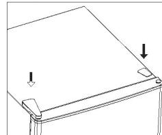
15. die Türdichtungen des Kühlschranks und des Gefrierschranks abnehmen und nach dem Drehen wieder anbringen.
