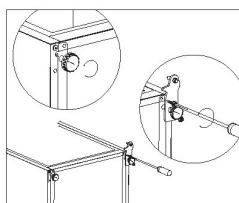
8. Desapertar e retirar o pino da dobradiça inferior, inverter o suporte e substitui-lo.
