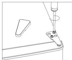
3. Retirar a tampa do orifício com uma chave de fenda plana.
