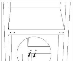
11. Ridicați aparatul și montați ușă pe balamaua inferioară. Asigurați-vă că mijlocul balamalei inferioare este introdus în orificiul ușii. Apoi mutați capacul orificiului balamalei ușii de jos din partea stângă în partea dreaptă.
