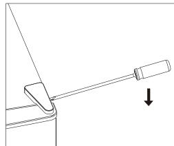
2. Odvijte zgornji tečaj s Philipsovim izvijačem.
