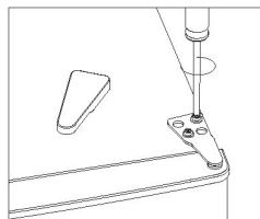
3. Scoateți capacul orificiului cu o șurubelnită plată.
