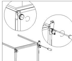
8 Lösen und entfernen Sie den unteren Scharnierstift, drehen Sie die Halterung um und setzen Sie sie wieder ein.
