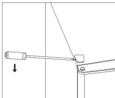
4 Bewegen Sie die Kernabdeckung von links nach rechts. Heben Sie danach die Tür an, und legen Sie diese auf eine gepolsterte Unterlage, um deren Zerkratzen zu vermeiden.
