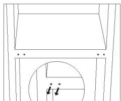
7. Porre il retro dell'armadietto su una superficie morbida. E svitare la cerniera inferiore e il piedino di livellamento.
