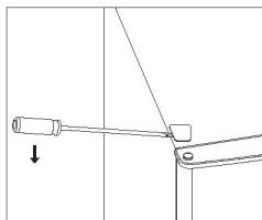
4. Mover a tampa do núcleo do lado esquerdo para o lado direito. E, em seguida, levantar a porta superior e colocá-la numa superfície acolchoada para evitar riscos.
