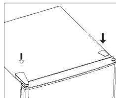
15. Odłącz uszczelki drzwi lodówki i zamrażarki, a następnie zamocuj je po obróceniu.
