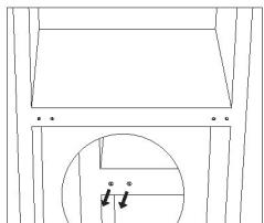
7. Allongez l'arrière de l'armoire sur un coussin mou. Dévissez ensuite la charnière inférieure et le pied de nivellement.
