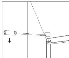
4. Mueva la tapa principal de izquierda a derecha. Y luego levante la puerta superior y colóquela en una superficie acolchada para evitar que se raye.
