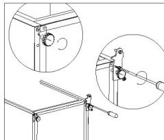
8. Desatornille y retire el pasador de la bisagra inferior, déle la vuelta al soporte y vuelva a colocarlo.
