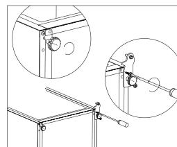
8. Odvijte in odstranite zatič spodnjega tečaja, obrnite držalo in ga zamenjajte.
