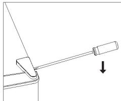
2. Schroef het bovenste scharnier los met een kruisschroevendraaier.
