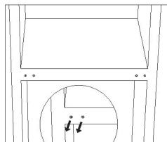
7. Așezați partea din spate a aparatului pe o suprafață moale. Deșurubați balama din mijloc și piciorul ajustabil.
