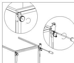
8. Svitare e rimuovere il perno della cerniera inferiore, girare la staffa e sostituirla.
