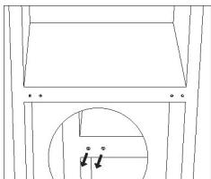
11. Podnieś urządzenie i umieść drzwi na dolnym zawiasie. Upewnij się, że dolny rdzeń zawiasu jest włożony w otwór na drzwi. Następnie przesuń osłonę otworu zawiasu dolnych drzwi z lewej strony na prawą.
