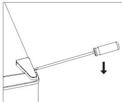
2. Desaparafusar a dobradiça superior com uma chave de fenda Philips.
