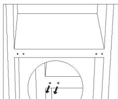
11. Redressez l'appareil et placez la porte sur la charnière inférieure. Assurez-vous que le noyau de la charnière inférieure est inséré dans le trou de la porte. Ensuite, déplacez le couvercle du trou de charnière de la porte inférieure de la gauche vers la droite.
