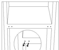
7. Plaats de achterzijde van de kast op een zachte mat. Schroef het onderste scharnier en de nivelleringsvoet los.
