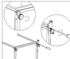
8. Schroef de schroef los en verwijder de onderste scharnierpen, draai de beugel om en vervang hem.
