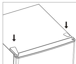
15. Odvojite brtve na vratima hladnjaka i zamrzivača, a zatim ih pričvrstite nakon okretanja.
