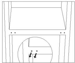
7 Legen Sie die Rückseite des Schrankes auf eine weiche Unterlage. Und schrauben Sie das untere Scharnier und den Nivellierfuß ab.
