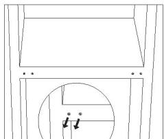
7. Apoye la parte trasera del aparato sobre una superficie acolchada. Y desatornille la bisagra inferior y el pie nivelador.
