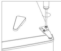
3. Retirez le couvercle de trou à l'aide d'un tournevis à tête plate.
