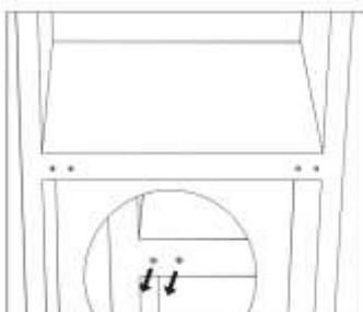
11. Σηκώστε τη συσκευή όρθια και τοποθετήστε την πόρτα στον κάτω μεντεσέ. Βεβαιωθείτε ότι ο πείρος του κάτω μεντεσέ έχει εισαχθεί στην οπή της πόρτας. Στη συνέχεια, μετακινήστε το κάλυμμα οπής του μεντεσέ της κάτω πόρτας από την αριστερή πλευρά στη δεξιά πλευρά.
