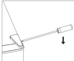
2. Deșurubați balamaua superioară cu o șurubelnită în cruce.
