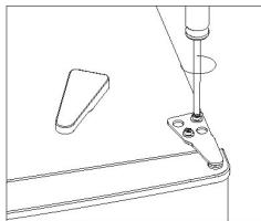
3 Entfernen Sie die Lochabdeckung mit einem flachen Schraubenzieher.
