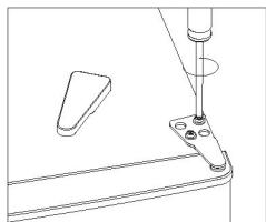
3. Verwijder de afdekking van de opening met een platte schroevendraaier.
