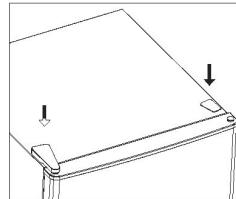
15. Verwijder de pakkingen van de deur van de koelkast en de diepvriezer en breng ze daarna opnieuw aan na de rotatie.
