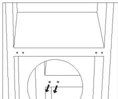
11. Levante el aparato y ponga la puerta en la bisagra inferior. Asegúrese de que el centro de la bisagra inferior se inserte en el hueco de la puerta. Entonces mueva la tapa del hueco de la bisagra de la puerta inferior de izquierda a derecha.
