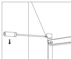
4. Mutati capacul orificiului din partea stângă în partea dreaptă. Apoi ridicăti ușa superioară și așezați-o pe o suprafață moale pentru a evita zgârierea.
