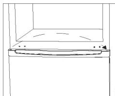
12. Installieren Sie das mittlere Scharnier.
