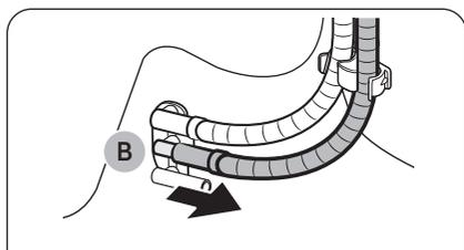
2. Rimuovere il tubo di scarico del serbatoio dell'acqua dal fermo (B) e collegarlo alla uscita dello scarico d'acqua (A).
