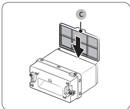
3. Inserire il **micro filtro opzionale morbido (filtro opzionale) (C)** in dotazione sul retro del coperchio interno come mostrato in figura.
