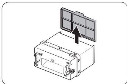
1. Aprire il coperchio esterno dello scambiatore di calore e rimuovere il coperchio interno. (vedere la sezione **"Scambiatore di calore"** a pagina 47).
