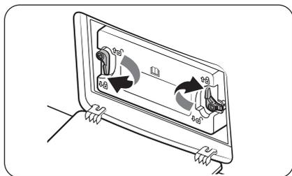
4. Rimontare il coperchio interno nella sua posizione originale e chiudere le leve di fissaggio.
