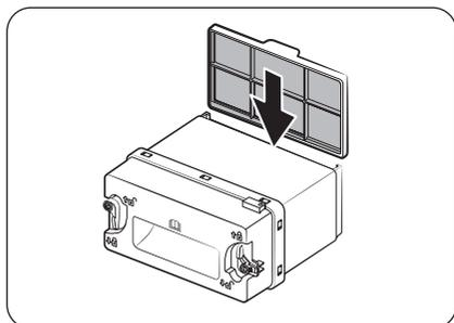
4. Inserire il filtro nel coperchio interno e reinsertire il coperchio interno nella posizione originale.
