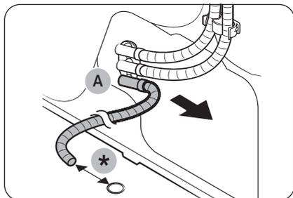
1. Rimuovere il lungo tubo di scarico dall'uscita dello scarico d'acqua (A).
