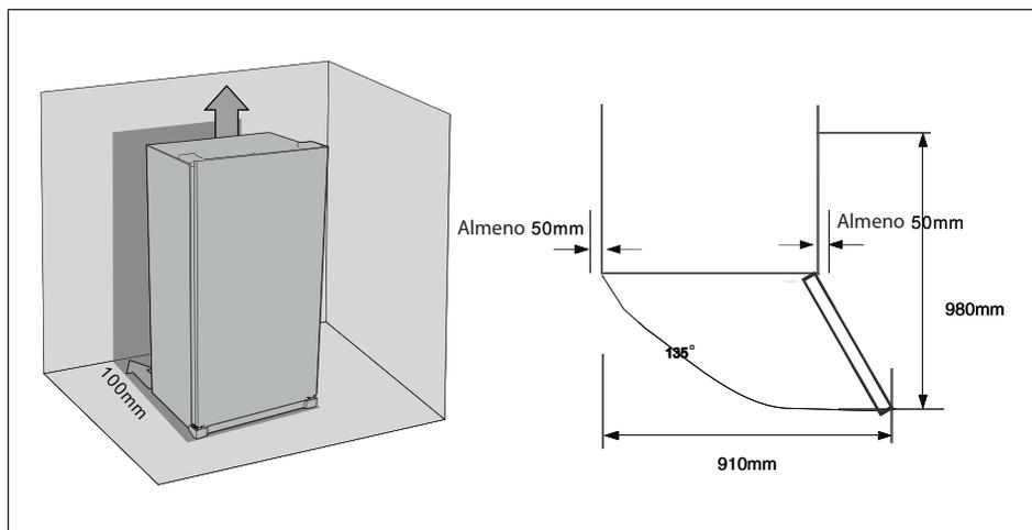
Appoggiate l'apparecchio su un pavimento solido in grado di sopportarne il peso anche quando è pieno. Evitate di appoggiarla su materiali elastici e risonanti che ne amplificherebbero il rumore. Regolate bene il livello orizzontale con gli appositi piedini.
