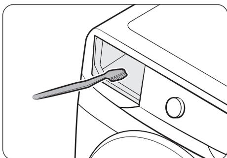
3. Pulire l'interno del cassetto usando una spazzola così da rimuovere eventuali residui di detersivo e di calcare.
