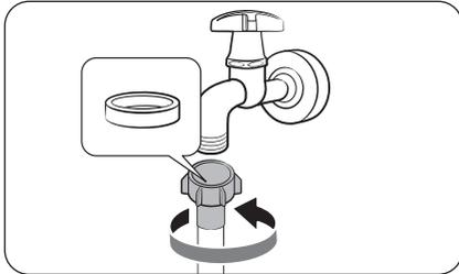
1. Collegare il tubo dell'acqua al rubinetto e ruotare il connettore in senso orario come mostrato in figura.
