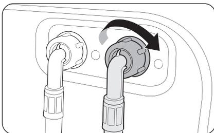
1. Collegare l'estremità rossa del tubo dell'acqua calda sulla valvola di carico dell'acqua calda sul retro della lavatrice.
