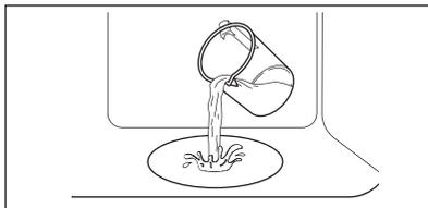
La capacità massima dell'incavo della cavità è 250 ml. Non riempire la goffratura della cavità con acqua durante la cottura o quando l'apparecchiatura è calda.
