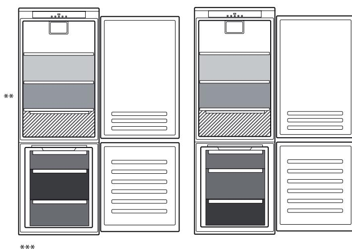
\*\* Pour les modèles avec un COMPARTIMENT « ZONE 0° », la « zone la plus froide » est celle mise en évidence dans la légende
