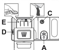
L'utilizzo di brillantante facilita il processo di ASCIUGATURA delle stoviglie. La vaschetta del brillantante **A** dovrebbe essere riempita quando l'indicatore ottico scuro posto sullo sportellino **C** diventa trasparente.
