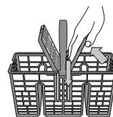
Le griglie tuttavia consentono anche di ottimizzare la disposizione delle posate al suo interno. Il cestello portaposate deve essere sistemato soltanto nella parte anteriore del cestello inferiore.
