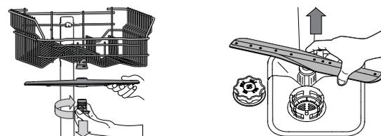
Per smontare il braccio aspersore superiore, ruotare l'anello di bloccaggio in plastica in senso orario.
