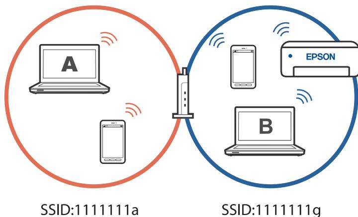
Per evitare che ciò accada, quando si desidera configurare una stampante in rete da un secondo computer, avviare il programma di installazione sul computer connesso alla stessa rete della stampante. Se la stampante si trova sulla stessa rete, la stampante non viene riconfigurata per la rete e la configura pronta per l'uso.
