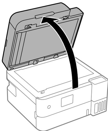
2. Pulire la superficie del vetro dello scanner con un panno morbido, asciutto e pulito.
