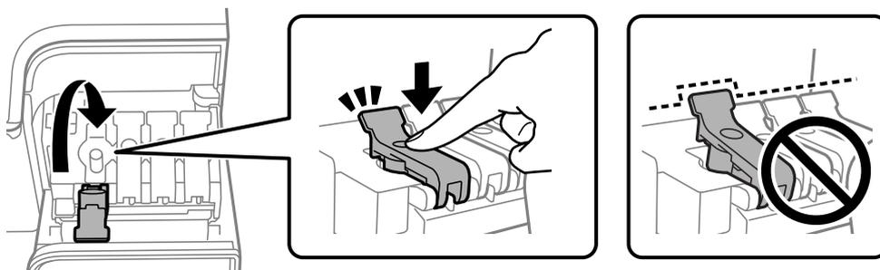
11. Chiudere saldamente il coperchio del serbatoio dell'inchiostro.
