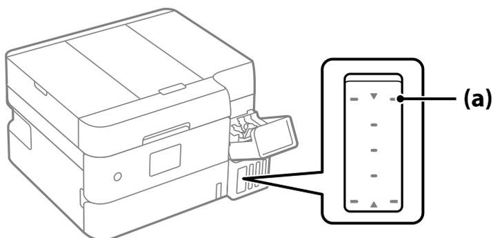
8. Allineare la parte superiore della bottiglia di inchiostro con la porta per il riempimento, quindi inserirla direttamente nella porta per versare l'inchiostro. Il flusso si interrompe automaticamente una volta raggiunta la linea superiore.
