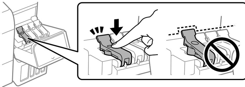
12. Chiudere saldamente il coperchio del serbatoio dell'inchiostro.
