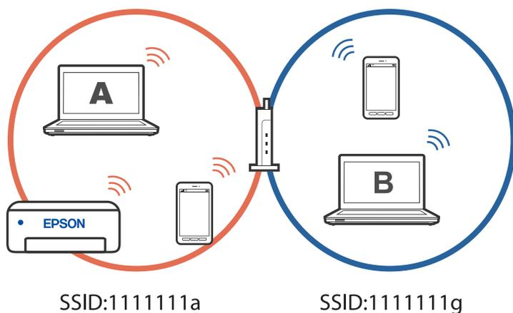
Inoltre, se si avvia la configurazione della stampante dal computer B nella configurazione mostrata sopra, la stampante viene configurata sulla rete del computer B consentendo al computer B di stampare, ma non al computer A.
