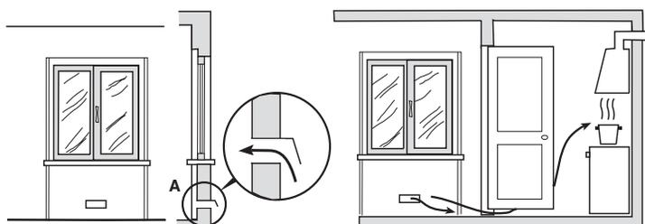
apertura di ventilazione per l'afflusso d'aria necessaria per una corretta combustione
