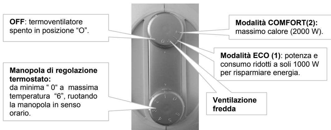
Il termostato mantiene la temperatura ambiente desiderata accendendo e spegnendo automaticamente il termoventilatore. Più la manopola è ruotata in senso orario, più la temperatura assicurata sarà elevata.
