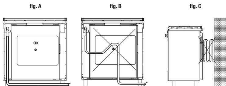
**Se il tubo e' danneggiato, non tentare di ripararlo ma sostituirlo con uno nuovo prima di utilizzare l'apparecchio.**
