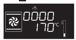
Ruotare la manopola a destra o a sinistra per impostare la durata di cottura da 00:01 a 12:59. Mantenere ruotata la manopola per avere un incremento o una diminuzione veloce.
