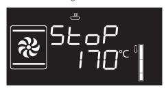
Per disattivare il segnale acustico premere o ruotare una delle due manopole oppure aprire la porta.
