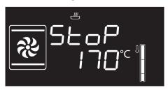
5. Per disattivare il segnale acustico premere o ruotare una delle due manopole oppure aprire la porta.
