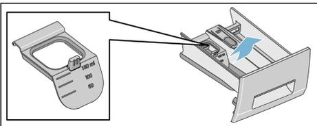
3. Lavare il cassetto del detersivo e l'inserto con acqua e una spazzola, e asciugarlo. Pulire anche l'interno della struttura.
