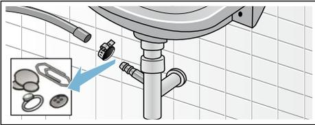
4. Ricollegare il tubo flessibile di scarico e assicurare il collegamento tramite la fascetta del tubo flessibile.
