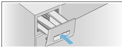
**Avvertenza:** Lasciare il cassetto del detersivo aperto in modo che ogni residuo di acqua si possa asciugare.
