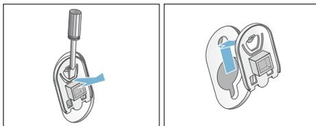
2. Inserire tutte e quattro le boccole. Fissare saldamente il cavo di alimentazione nei supporti. Inserire e stringere le viti.
