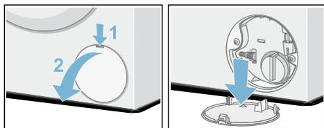
4. Rimuovere il tubo flessibile di scarico dal supporto. Rimuovere il tappo di chiusura e permettere all'acqua di fluire nell'apposito contenitore.
