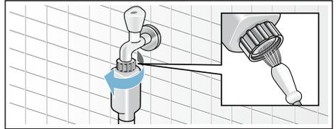
6. Per modelli standard e Aqua-secure, pulire il filtro sul retro dell'apparecchio: Rimuovere il tubo flessibile dal retro dell'apparecchio. Utilizzare delle pinze per rimuovere il filtro e pulirlo.
