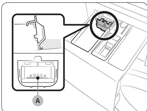
Inserire per prima la guida per liquidi in dotazione nel **II comparto lavaggio principale**. Quindi, versare il detersivo liquido nella guida al di sotto della linea max (A).
