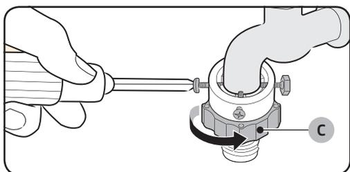
4. Inserire l'adattatore nel rubinetto di carico dell'acqua e serrare le viti sollevando allo stesso tempo l'adattatore.
