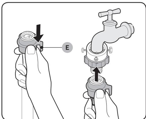
6. Tenendo premuto il **componente (E)**, collegare il tubo di carico dell'acqua all'adattatore. Quindi, rilasciare il **componente (E)**. Il tubo si inserisce nell'adattatore con un clic.
