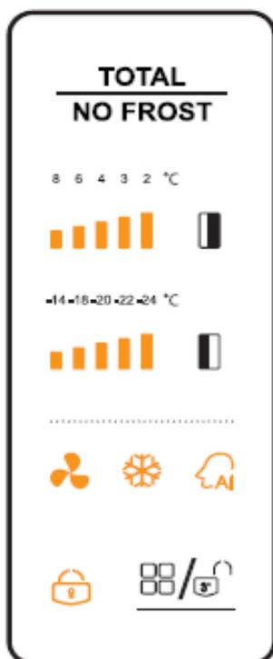
Quando l'apparecchio viene acceso per la prima volta, il pannello di controllo si illumina completamente. Il pannello si spegne automaticamente dopo 60 secondi di inattività.
