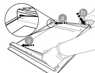
**4.** Rimontare il profilo superiore: un clic indica il corretto posizionamento. Verificare che la tenuta sia salda prima di rimontare la porta.
