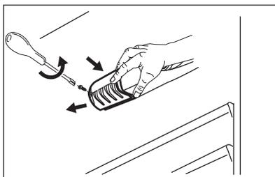
3. Sostituire la lampadina con una nuova della stessa potenza (la potenza massima è indicata sul
