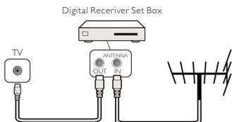
Utilizzare 2 antenne per collegare l'antenna del Set-top box (un ricevitore digitale) e il televisore.
