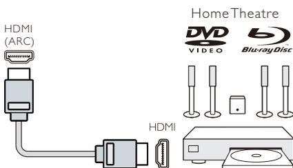
Utilizzare un cavo HDMI per collegare un sistema Home Theatre (HTS) al televisore. Si può collegare una Soundbar Philips o un HTS con un lettore integrato.
