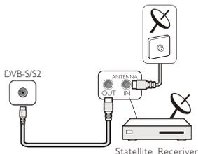
Collegare il cavo della parabola al ricevitore
