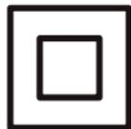
В целях обеспечения Вашей безопасности настоящий прибор оснащен двойной изоляцией. **CE**
