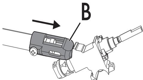
3. Riportare il supporto "B" nella posizione iniziale, in modo da coprire completamente l'ugello "C".
