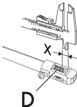
4. Regolare l'afflusso d'aria spostando il tubo Venturi "D", fino ad ottenere la distanza "X" riportata nelle tabelle relative (vedi "Tabella caratteristiche bruciatori e ugelli", alla voce "Aria primaria (mm)"); successivamente, stringere la vite "A".
