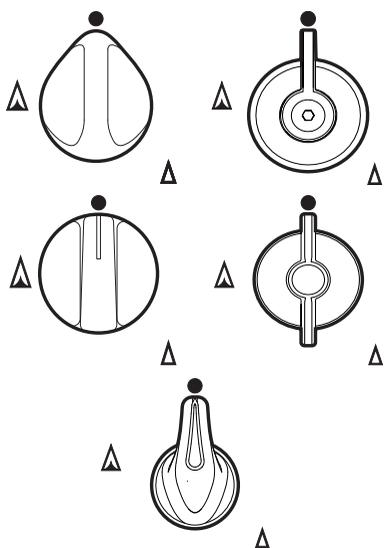
Utili per accendere e regolare i bruciatori del piano. Premere e ruotare in senso antiorario sul valore ▲ per accendere i bruciatori corrispondenti. Ruotare le manopole sulla zona compresa tra il massimo ▲ e il minimo ▲ per regolare la fiamma. Riportare le manopole sulla posizione ● per spegnere i bruciatori.
