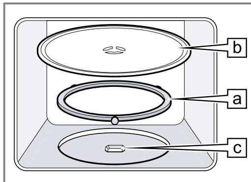
2. Den Drehteller **b** in den Antrieb **c** in der Mitte des Garraumbodens einrasten.
