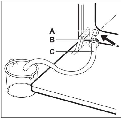
3. Aprire la porta del forno e collegare il connettore (B) alla valvola di scarico (A).
