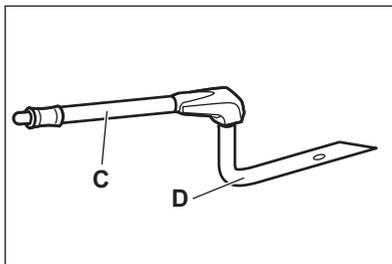
"C" rappresenta il tubicino dell'iniettore per la cottura a vapore, "D" l'iniettore per la cottura a vapore diretto.
