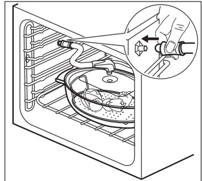
Assicurarsi di non schiacciare il tubicino dell'iniettore e che non entri in contatto con la resistenza sulla parete superiore del forno.
