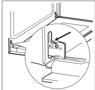
2. Sollevare e ruotare completamente le leve sulle due cerniere.
