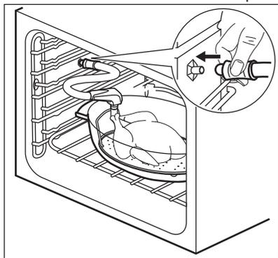
2. Sistemare la teglia sul primo o secondo livello a partire dal basso. Assicurarsi di non schiacciare il tubicino dell'iniettore e che non entri in contatto con la resistenza sulla parete superiore del forno.
