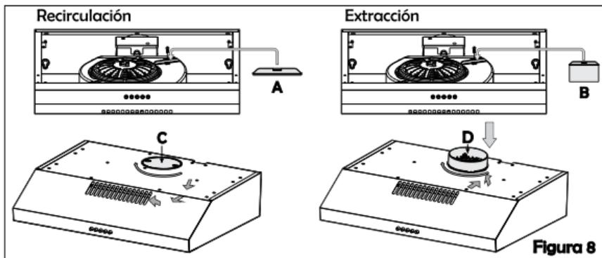
Si raccomanda di **VERIFICARE CHE IL CUSCINETTO SIA CORRETTO**. Il cuscinetto è posizionato sull'unità del motore e per la versione di scarico dovrà essere installato il cuscinetto B.
