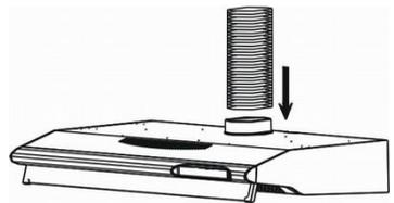
Percer le trou pour la sortie d'air (133 mm de diamètre) dans la cuisine.
