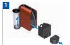
Retire o depósito de água e o recipiente de cápsulas. Ajuste o comprimento do cabo e acondicione o excesso debaixo da máquina.
