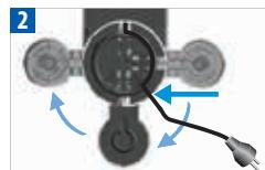
Coloque o cabo remanescente na guia debaixo do depósito de água encaixado à esquerda ou à direita dependendo da posição escolhida para o depósito de água e coloque a máquina na posição vertical.
