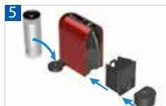
放置水箱於手製上，由磁石固定位置。放入滴水格及膠囊容器於正確位置。為安全起見，滴水格及膠囊容器必須放置正確位置。 установите поддон для капель и контейнер для использованных капсул. Для вашей безопасности используйте кофемашину только тогда, когда поддон для капель и контейнер для использованных капсул установлены на машину. Установите резервуар для воды на ручку, фиксируемую магнитами.
