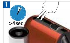
Pressione e mantenha pressionadas as teclas Espresso e Lungo em simultâneo pelo menos por 4 segundos. As outras teclas piscam.
