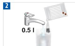
Coloque 1 unidade de líquido descalcificante Nespresso no depósito de água e adicione 0,5 l de água.
