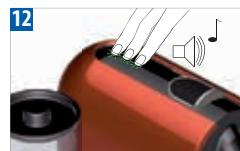
Para sair do modo de descalcificação, pressione as 3 teclas simultaneamente durante mais de 3 segundos. Um pequeno som irá confirmar essa operação. A máquina está pronta para utilização.
