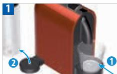
De salientar, a máquina fica bloqueada durante 10 minutos após o esvaziamento! Remova o depósito de água. Coloque um recipiente debaixo da saída de café.
