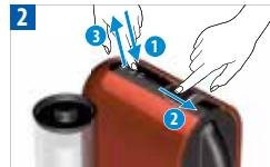
Pressione e mantenha pressionada a tecla enquanto fecha o deslizante. Solte a tecla quando atingido o volume desejado. As outras 2 teclas piscam. O volume de água está agora memorizado na tecla usada para a programação.
