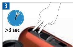
Para alterar o modo OFF automático de 9 para 30 minutos, com o deslizante fechado, pressione e mantenha pressionadas as teclas Lungo e Ristretto por mais de 3 segundos. A tecla Espresso pisca 1 vez. Para repor os 9 minutos, repita o mesmo procedimento. A tecla Espresso pisca 3 vezes.
