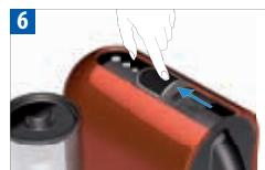
Coloque a máquina em ON ao abrir o deslizante, empurrando-o para a parte de trás da máquina. Luz intermitente numa das teclas de café: em aquecimento durante cerca de 25 segundos. Luz fixa: pronta.
