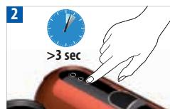
A máquina pode ser colocada em modo OFF a qualquer momento quando o deslizante está fechado, pressionando qualquer tecla por mais de 3 segundos, confirmado pelas outras 2 teclas que piscam.
