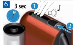
欲進入咖啡機清洗程序，請於滑桿關閉之情況下，同時按壓 3 個控制鈕至少 3 秒。咖啡機將會發出一聲簡短的嗶聲，作為確認。打開滑蓋。
