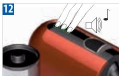
Aby wyjść z trybu odkamieniania, należy naciąć jednocześnie wszystkie trzy przyciski i przytrzymać przez dłużej niż 3 sekundy. Krótki sygnał dźwiękowy potwierdzi wyjście z trybu odkamieniania. Urządzenie jest gotowe do użytku.
