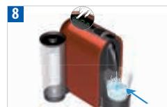
Coloque um recipiente debaixo da saída de café. Pressione o botão Lungo. Feche o deslizante para enxaguar a máquina. Repita três vezes.
