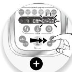
2- Ensuite réglez le(s) paramètre(s) à l'aide du sélecteur +/- (**B6**). Pour des raisons de sécurité, il n'est pas possible de régler une température sans régler un temps de cuisson.
