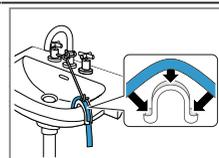
Raccordo di scarico in una condotta di plastica con manicotto in gomma oppure in un pozzetto.
