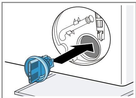
Accertarsi che i componenti del coperchio della pompa sia montati saldamente.
