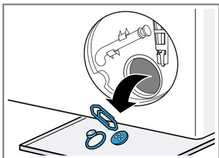
3. Accertarsi che l'elica della pompa di scarico possa ruotare.
