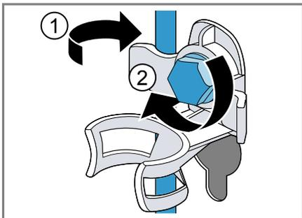
5. Inserire il tubo flessibile nell'alloggiamento.
