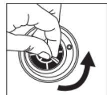
Per la sostituzione del filtro togliere il tappo della bottiglia, ruotare il filtro in senso antiorario e rimuoverlo tirandolo verso l'alto. Sostituirlo con uno nuovo ripetendo le operazioni come da paragrafi "PREPARAZIONE DEL FILTRO FAST DISK™".
