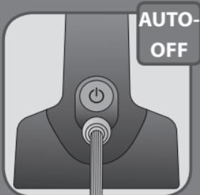
**ES** Su aparato tiene una función de apagado automático que lo apagará automáticamente tras 5 minutos si usarse. Para volver a activar el aparato, consulte el apartado «3. USO»
