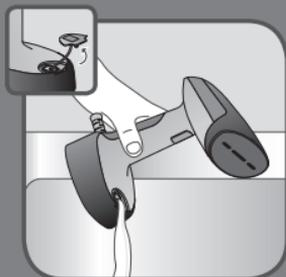
**ES** Vacíe totalmente el depósito de agua y, a continuación, cierre la tapa de la entrada de agua.
