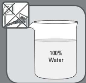
**NL** Open de dop van het waterreservoir en vul hem 100% met onbehandeld kraanwater tot het maximum niveau en herhaal de voorafgaande procedure totdat het waterreservoir leeg is om uw apparaat te reinigen.
