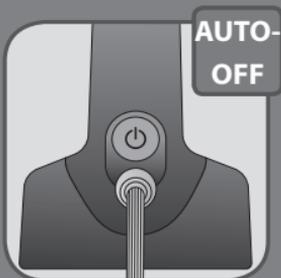
**NL** Uw apparaat bezit een automatische uitschakeling waardoor het apparaat na ongeveer 5 minuten waarin het niet wordt gebruikt, wordt uitgeschakeld. Om het apparaat opnieuw te starten, kunt u kijken in «3. GEBRUIK».
