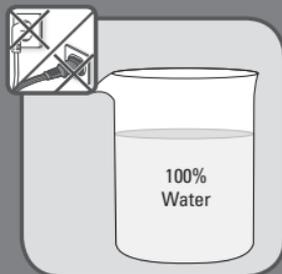
**ES** Abra la tapa de entrada del depósito de agua y llénelo al 100% con agua del grifo no tratada hasta el nivel máximo y repita el proceso anterior hasta que el depósito de agua se haya vaciado por completo con el fin de enjuagar el aparato.
