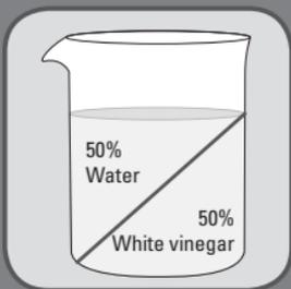
**NL** Vul de maatbeker met 50% onbehandeld kraanwater en 50% witte azijn en giet dit in het waterreservoir van het apparaat.
