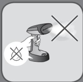
**NL** Houd het apparaat ingeschakeld totdat het waterreservoir volledig leeg is.
