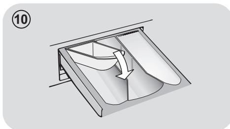
**EINIGE MODELLE** sind mit einer automatischen Dosierung ausgestattet, die Waschmittel und Weichspüler exakt dosiert. In diesem Fall ziehen Sie den spezifischen Abschnitt im Kapitel **STEUERUNG UND PROGRAMME** für weiterführende Informationen hinzu.
