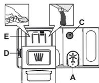
L'utilizzo di brillantante facilita il processo di ASCIUGATURA delle stoviglie. La vaschetta del brillantante **A** dovrebbe essere riempita quando l'indicatore ottico scuro posto sullo sportellino **C** diventa trasparente.
