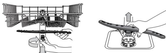
Per smontare il braccio aspersore superiore, ruotare l'anello di bloccaggio in plastica in senso orario.
