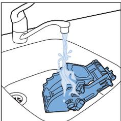
6 Enxágue a parte exterior da unidade de preparação em água corrente tépida.
