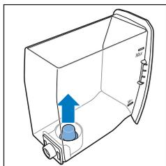
2 Retire o filtro da embalagem e mergulhe-o em água fria com a abertura voltada para cima. Pressione suavemente ambos os lados do filtro para permitir a libertação das bolhas de ar.
