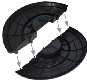
Renverser l'appareil, poser la base sur le corps de chauffe et la fixer avec les 6 vis fournies, en les serrant correctement.
