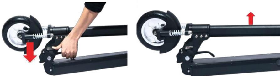
2. Spingere la leva verso l'alto fino a bloccare la leva di fissaggio.
