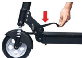
4. Spingere leggermente in avanti la barra dello sterzo, aprire la seconda leva di piegatura (si sente un clic) e continuare a piegare il telaio fino a quando si inserisce nel meccanismo di blocco (si sente un altro clic).
