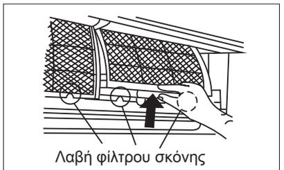
2. Πιάστε τη λαβή του φίλτρου σκόνης και σηκώστε το ελαφρά για να το αφαιρέσετε από τη βάση του φίλτρου.
