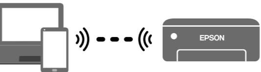
Non è possibile connettere computer o dispositivi intelligenti direttamente alla stampante senza un router wireless. Se non è possibile collegarsi utilizzando una connessione Wi-Fi Direct, consultare la *Guida utente*.
