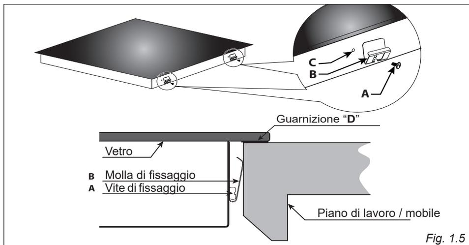
**IMPORTANTE:** Stendere la guarnizione "D" intorno al bordo del piano di cottura (bordo del vetro). La guarnizione "D" deve essere installata correttamente per garantire una perfetta sigillatura fra apparecchio e mobile. Una errata installazione può danneggiare in modo irreversibile l'apparecchio.
